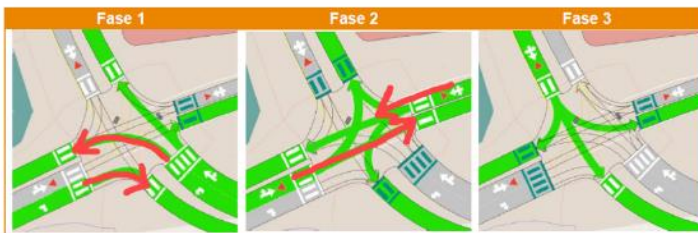
Figur 6-2. Faser i Posthuskrysset.
